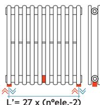
Conexiones hidráulicas soldadas
