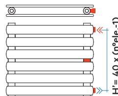
Conexiones hidráulicas soldadas
