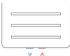
Conexión Bitubo por abajo con entre eje 50 mm.
