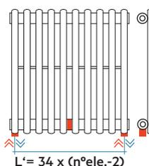
Conexiones hidráulicas soldadas
