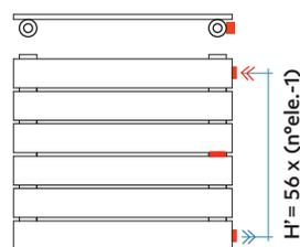
Conexiones hidráulicas soldadas
