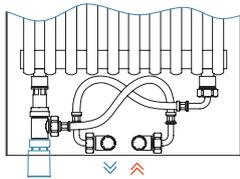
Innovador sistema de conexión hidráulica oculto mediante tubos flexibles de alta calidad, con tomas centrales inferiores de 1/2" con entre eje de 50 mm, con una tolerancia de 25 mm, a cada lado, incluye adaptador para cabezal termostático.
