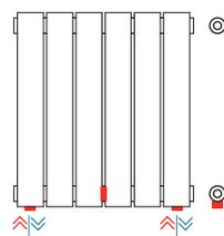
Conexiones hidráulicas soldadas
