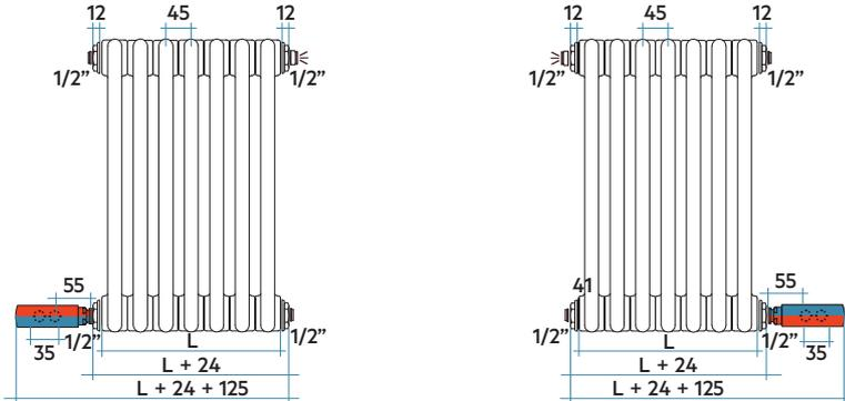
**TOMAS MONOTUBO INFERIOR Código T24:** Incluye 1 manguito inferior de 1/2" SOLO compatible con los modelos TESI 3 columnas y 5 columnas. Se debe indicar elemento de entrada/salida. NO NIPLABLE. **Incremento de precio 48,00 €**
