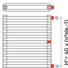
Conexiones hidráulicas soldadas
