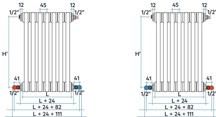
Para baterías TESI con altura superior a 1000 mm y menos de 15 elementos, se debe pre-instalar un diafragma en el lado de la entrada del agua.
