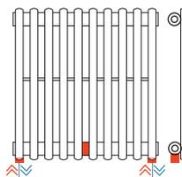
Conexiones hidráulicas soldadas
