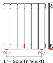
Conexiones hidráulicas soldadas
