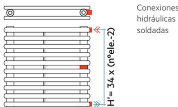
Conexiones hidráulicas soldadas
