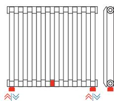
Conexiones hidráulicas soldadas
