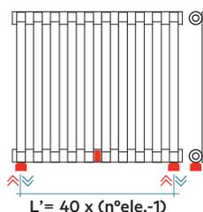
Conexiones hidráulicas soldadas
