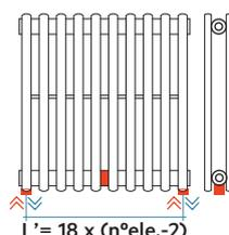
Conexiones hidráulicas soldadas
