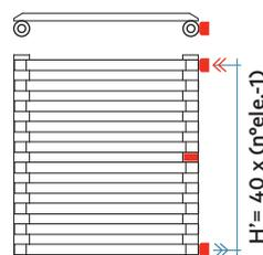
Conexiones hidráulicas soldadas
