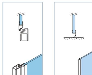
Perfil con cierre magnético. Apertura Interior o exterior. Cierre contacto. Apertura interior o exterior.
