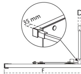
F simboliza la dimensión de la mampara desde la pared hasta el final de la guía. El ancho de la barra en su base es D=26 mm. Para que la mampara quede enrasada al borde del plato, no hay que retranquear los perfiles verticales. Con la mampara totalmente cerrada, el ancho total de fijo mas corredera es F-35 mm.
