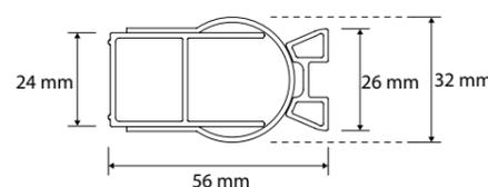
El conjunto de perfiles tiene una medida de 56 mm. El ancho del perfil a pared es de 24 mm, mientras que el perfil que marca los grados tiene un ancho de 26 mm. El diámetro del perfil circular es de 32 mm.
